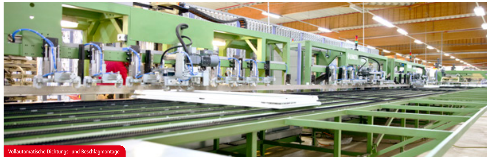
Vollautomatische Dichtungs- und Beschlagmontage
